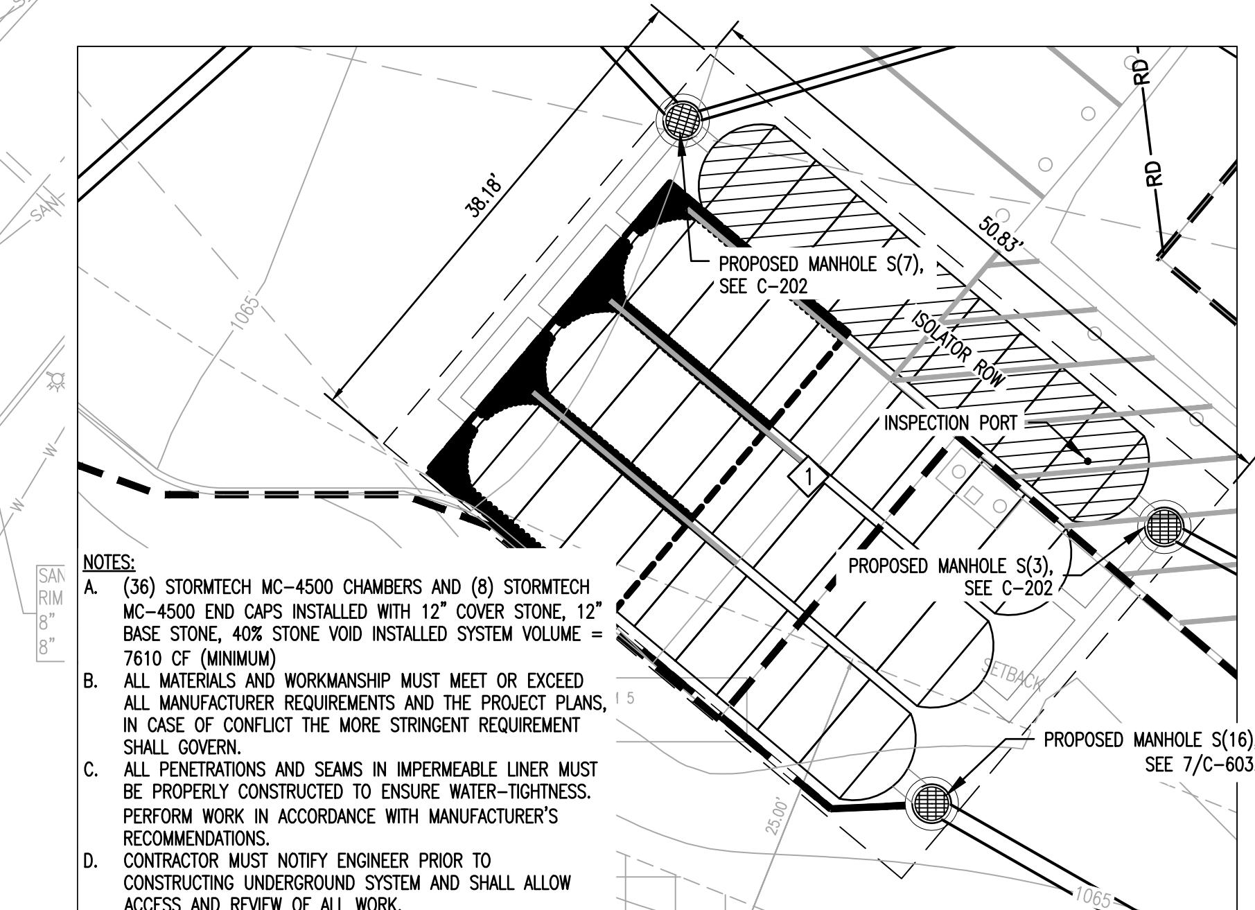
1 STORMTECH UNDERGROUND STORAGE SYSTEM CS-1 (ENLARGED PLAN)
